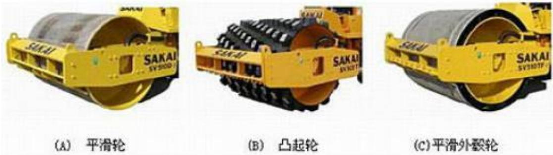
图5：酒井的土工用振动压路机的多种振动轮
