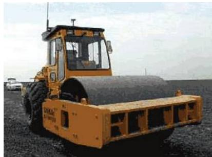
图2：在新关西国际机场使用的SV900DV型垂直振动压路机
