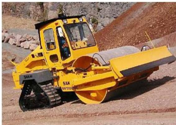
图3：世界首台履带式 CV550D 型振动压路机
