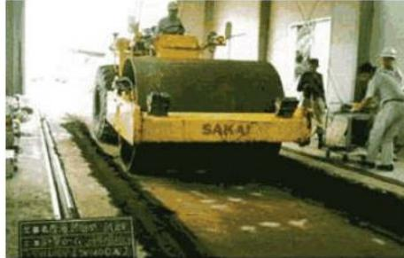
图1：酒井重工业技术研究所土壤室内压实试验装置（旧SV160DV型）
