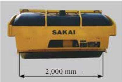
SW888-1碾压宽度
