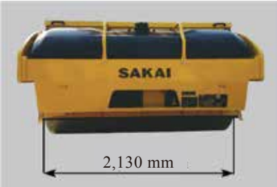
SW988-1碾压宽度
