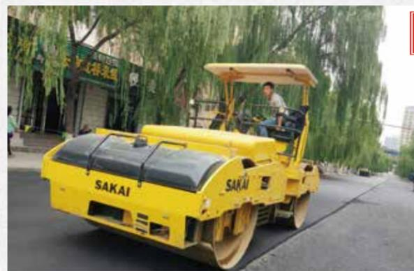
振荡模式适用于隧道摊铺、桥面摊铺、薄层碾压等施工
